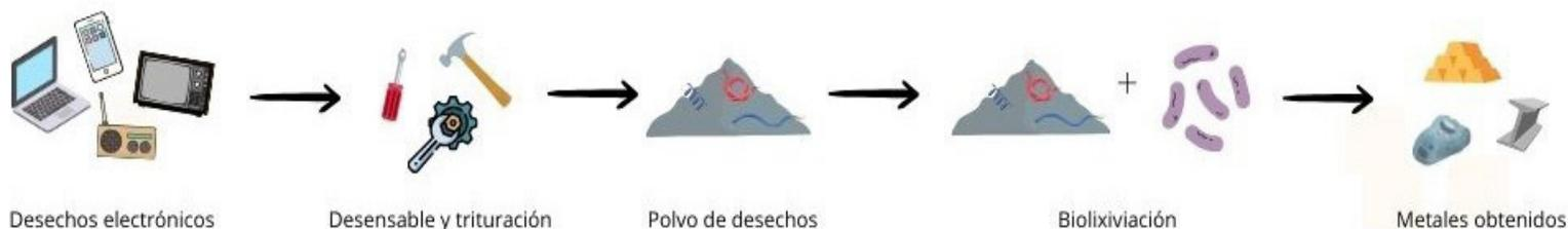
Figura 4. Tratamiento general de los desechos electrónicos para la obtención de metales.
