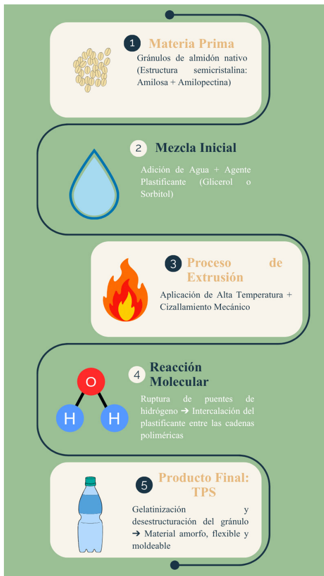
Figura 2. Proceso de obtención del almidón termoplástico (TPS), desde el gránulo de almidón nativo hasta el material amorfo, flexible y moldeable. Las etapas muestran que se trata solo de una transformación física del almidón, sin cambiar su composición química.
