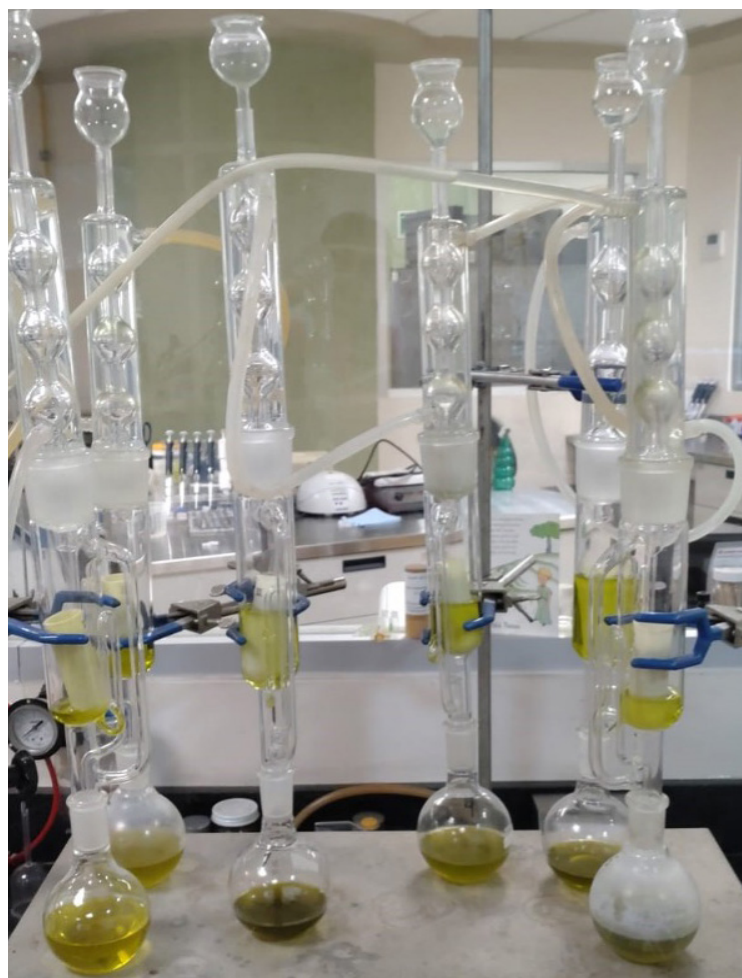
Figura 2. Extracción Soxhlet para obtener aceite esencial de romero ( Salvia rosmarinus ). Imagen de Ana Karen Gálvez-Larios.
