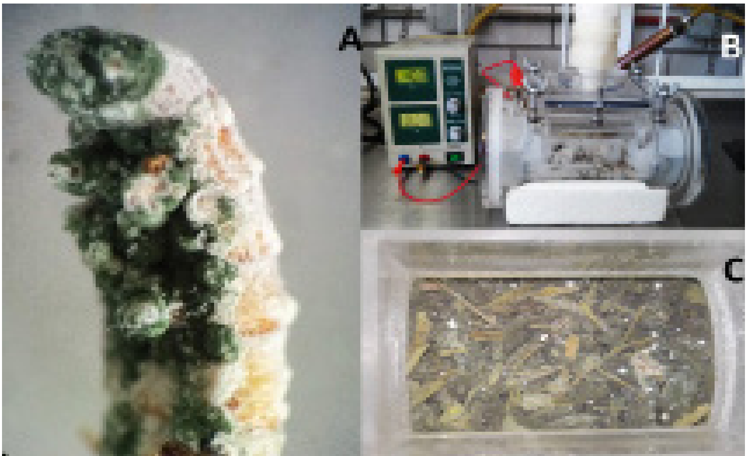
Figura 1. A) Larva infectada por el hongo entomopatógeno Metarhizium anisopliae . B y C) Reactor para aplicación del campo eléctrico como estímulo transitorio a M. anisopliae .
