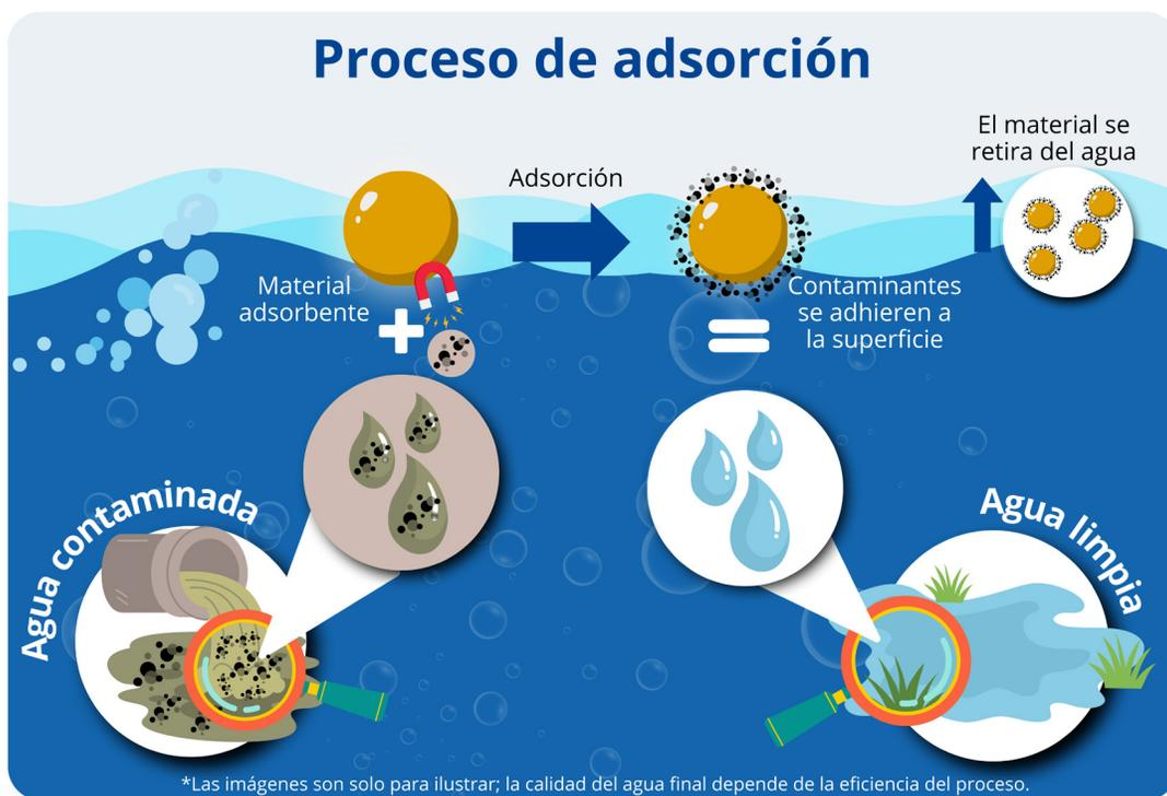
Figura 5. Adsorción de contaminantes en la superficie de materiales altamente porosos [Elaboración propia].
