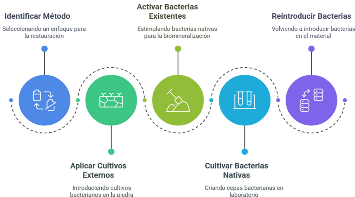
Figura 5. Conservación del patrimonio impulsado por bacterias carbonatogénicas. a) generalidades, b) Soluciones con bacterias carbonatogénicas en superficies deterioradas. (Imagen propia).
